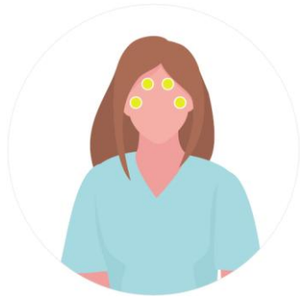
Figur 2. Exempel på områden av intresse för beräkningar av puls och syremättnad i Vitacam V2.
